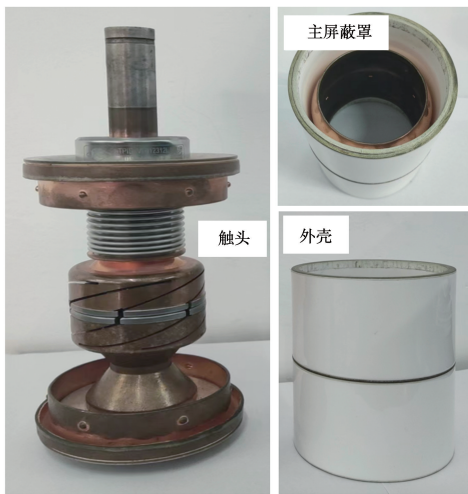
图1 真空灭弧室实际样机
